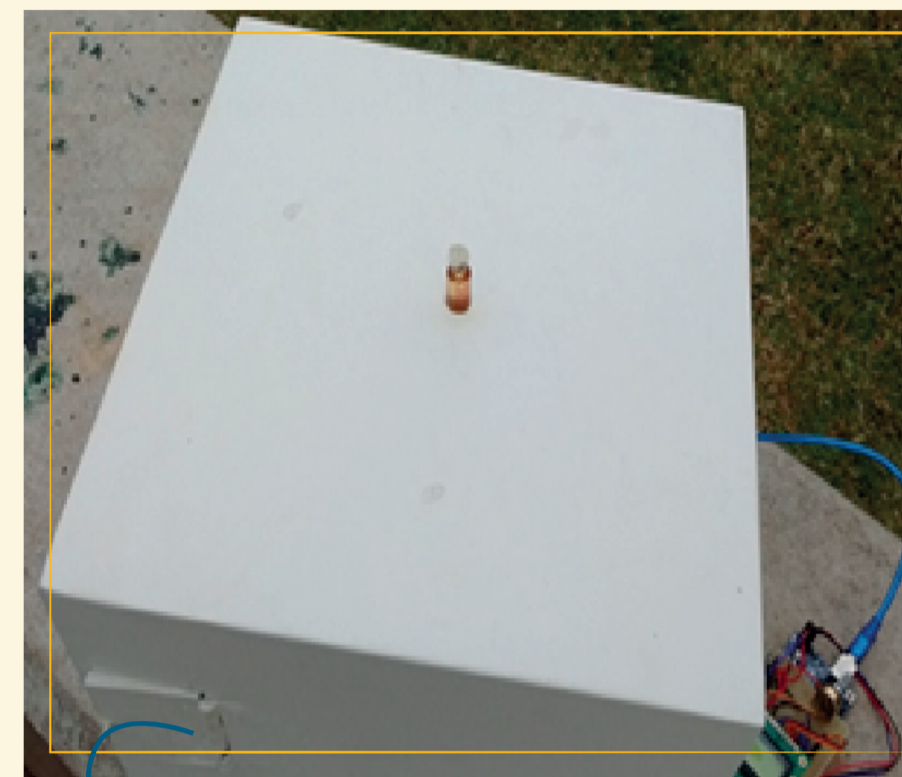
Figura 4. Protótipo com a lâmpada de Moser colorida e sensores
