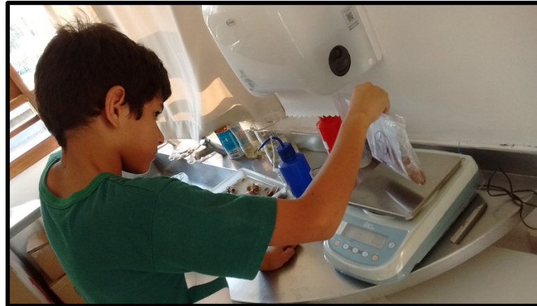
Figura 14. Verificação da massa das amostras coletadas em balança semi analítica
